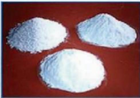
دارند و به عنوان عایقهای خوب حرارتی و صوتی بکار می‌روند. صفحات جذب صدای از مخلوط پرلیت و آزیست برس شده تهیه می‌گردند. تخته پرلیت، عایق حرارتی صلبی است که از پرلیت منبسط، الاف مسلح گشته و مواد چسبانده ساخته می‌شود. آن را می‌توان به صورت یک تخته یا به صورت تخته‌های دوتابی یا چندتابی چسبانده شده به یکدیگر با یک چب مناسب عرضه کرد. تخته‌ها ممکن است همچنین دارای لبه شکل داده شده باشند.
