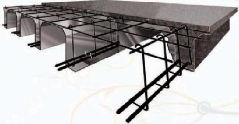
TASISATI و بر قی ایجاد می‌شود. به این ترتیب زمینه اجرای تاسیسات در فواصل خالی زیر سقف و مابین تیرچه‌ها فراهم می‌شود و در نتیجه با حذف اجرای تاسیسات روی سقف و زیر سازی‌های مربوطه، غسخامت سقف کاهش می‌باید. کاهش غسخامت سقف، موجب کاهش وزن تمام شده
