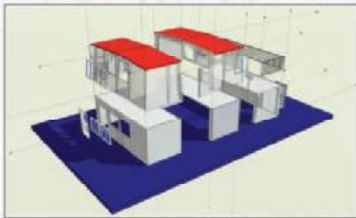
سیستم سازه های بتن مسلح پیش ساخته مدولار سه بعدی یا سیستم خانه سازی مدولار جعبه ای، یک سیستم ساختمانی کامل است که از مدول های جعبه ای شامل دیوار و سقف تشکیل شده است. این مدول ها به دو صورت در کارخانه تولید و به کارگاه منتقل می شوند و پس از سرمه بندی مدول ها بک ساختمان کامل را تشکیل می دهد. مدول های اصلی این سیستم عبارتند از مدول میانی، شامل دو دیوار پیرامونی و سقف و مدول انتهائی، شامل سه دیوار پیرامونی و سقف. نکه قابل توجه در این خصوص امکان اجرای سقف شیدار برای این ساختمان ها می باشد.
