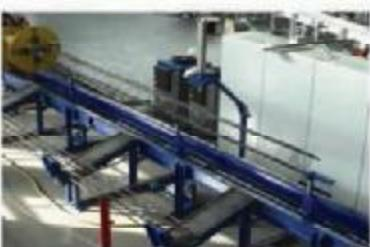
دستگاه تولید شبکه آرماتور جوش شده با جوش مقاومتی
