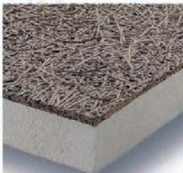
فناوری پانل‌های الاف بتن در زمرة اجزاء ساختمانی غیرباربر و غیرسازه‌ای قرار می‌گیرند و با توجه به مواد تشکیل‌دهنده، دارای وزن کم و سازگاری زیاد با محیط زیست می‌باشد. این پانل‌ها از مجموعه فرآوردهای پشم چوب کارخانه‌ای محسوب می‌شود و مواد اصلی تشکیل‌دهنده آن‌ها، سیمان و چوب می‌باشد که در طول فرآیند تولید، برخی مواد افزودنی به آن‌ها اضافه می‌شود و ناشانه چوب، که به عنوان منع حمله حشرات مอดی محسوب می‌شود، از آن حذف می‌شود.
